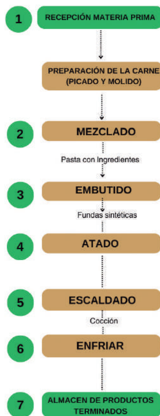
GRÁFICO 30 PROCESO DE PRODUCCIÓN MORTADELA
