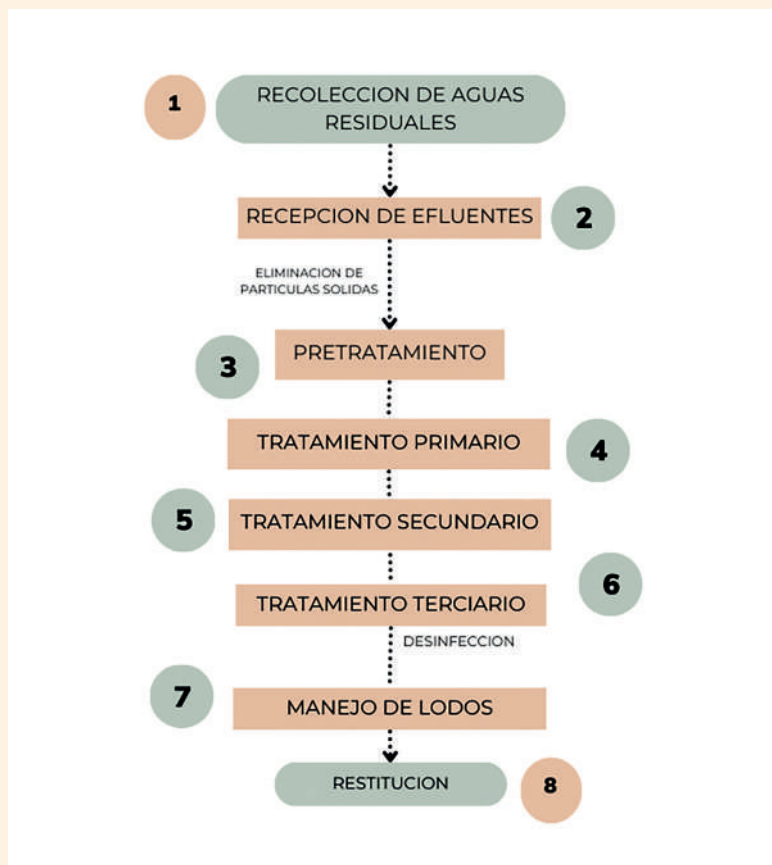
GRÁFICO 28 FLUJOGRAMA DEL PROCESO DE TRATAMIENTO DE AGUA RESIDUAL
