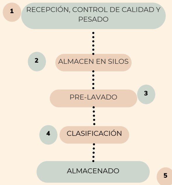
GRÁFICO 19 FLUJOGRAMA PROCESO INDUSTRIAL DE ACOPIO Y ALMACENAJE DE PAPA
