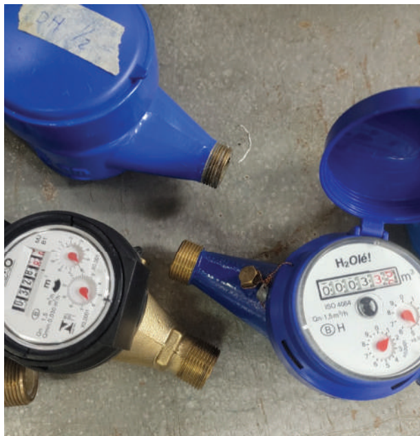
Medidores de agua potable
