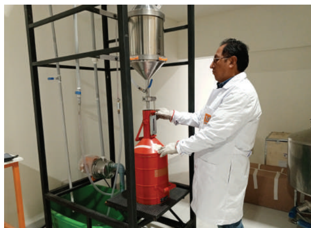
El Laboratorio de Grandes Volúmenes brinda servicios de calibración para recipientes volumétricos
