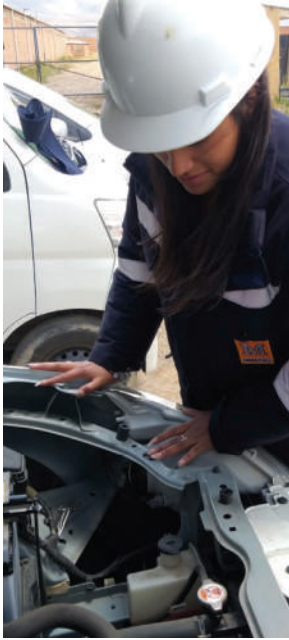
La DML inspecciona los reguladores de presión en kits de conversión a GNV
