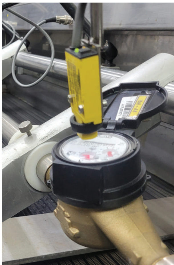
Bancada de sensores para medidores de agua
