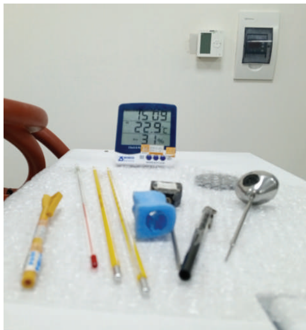
Variedad de termómetros en proceso de calibración
