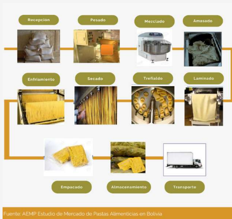
Figura 3: Proceso de fabricación de pastas, macarrones y fideos
